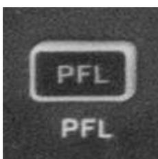
当这PFL开关被点亮时,推子前信号送到耳机,监听和电平指示。在显示屏上的虚拟开关是同步显示,点亮表明PFL有效,在不中断主混音信号下这是一种有效的监听方法,为了调整或问题追踪,当控制台上的PFL被按下,监听输出自动从混合输出转换。
