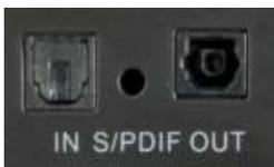
此接口为光纤输入与输出，在数字通道中切换，点选音源用Fn旋钮选择到声卡（soundcard）。
