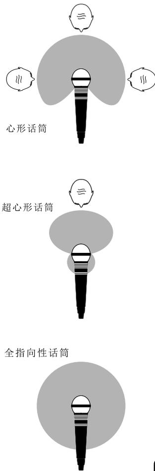
细致的话筒布置和选择——合适的话筒是扩声工作的成功之一。左图显示最常见类型的话筒与不同的拾音方式。心形话筒从前面对声音最敏感，而超心形话筒提供更多的方向性，话筒背面拾音少，作为录音歌手或乐器声是最理想的类型，其中重要的是拒绝了不想要的声音与反馈消除。尽量将话筒靠近身体对准输入源，可以消减不想要的声音，可以降低调音台的增益，避免反馈。同样选择一个好的话筒与摆放位置没有明显的平衡。目前还没有确切标准——让你的耳朵可以判断。最后达到期望效果是好的位置。
