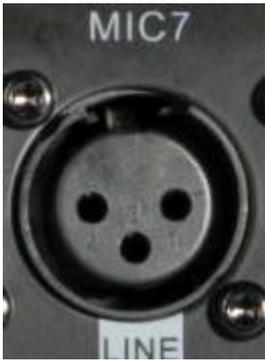
此话筒输入采用XLR类型连接座被设计为适合广泛平衡或非平衡信号,专业的动态,最好是电容或铝带话筒。因为它们是低阻抗的,你可以使用低成本高阻抗话筒,但背景噪声会高些,如果你打开幻象电源(参量EQ面板下方),此插座为专业的电容话筒提供+48V的电压。
