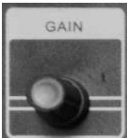
这个钮设置信号源的大少剩余部分送到混音器,太高,这通道过载信号失真;太低,这背景噪声将更加明显,在混音器的输出你不能够获得足够的信号电平。注意:某些音频设备,特别是家用设备,运行在比专业设备还要的低电平(-10dB),因此需要高的增益来获得同样的输出电平。
