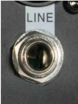
采用3针A规格的插孔,除了话筒用此作为输入源,如键盘乐器,架子鼓,合成器,母带机,或吉它,这个输入是平衡为低噪声高质量的专业的设备,但你可以作为非平衡输入源通过接线如下所示,仍然您保留电缆长度越短越好,如你想用这个插孔要拔掉MIC上输入话筒,使用GAIN钮设置输入电平。
